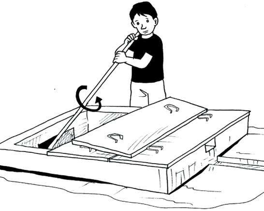
Lapisan sampah yang mengeras sering terjadi karena jerami atau kotoran kering terkumpul dan mengapung di permukaan kohe di dalam kubah. Lapisan itu merupakan halangan bagi pengaliran gas dari reaktor ke penampung gas. Karena terhalang lapisan tersebut, gas mengalir keluar dari *manhole* ke *outlet*. Jika pengisian dilakukan dengan benar, masalah ini tidak akan muncul.
